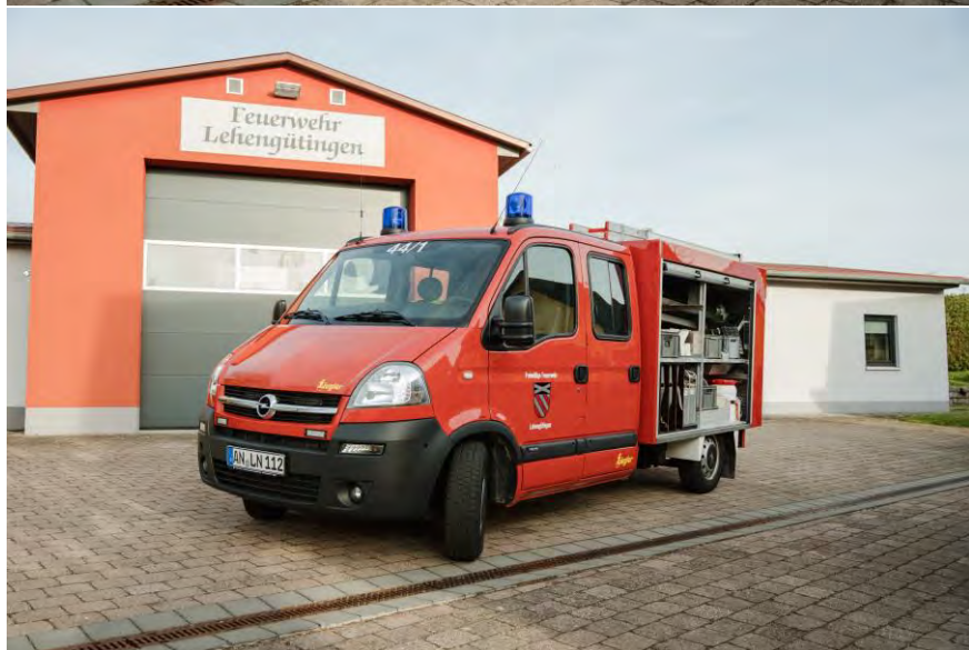
2007 neues TSF auf Opel Movano mit neuer TS 8/8 Ultra Power 2 der Fa. Ziegler
